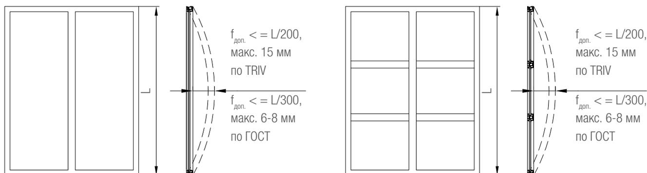
Рисунок 2: допустимые прогибы под действием ветровой нагрузки
