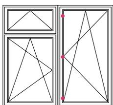
Соединение элементов с несколькими створками, со стыком одной створки по всей длине соединения:
