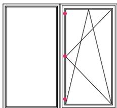
Соединение элементов с глухим остеклением и створкой, со стыком створки по всей длине соединения:
