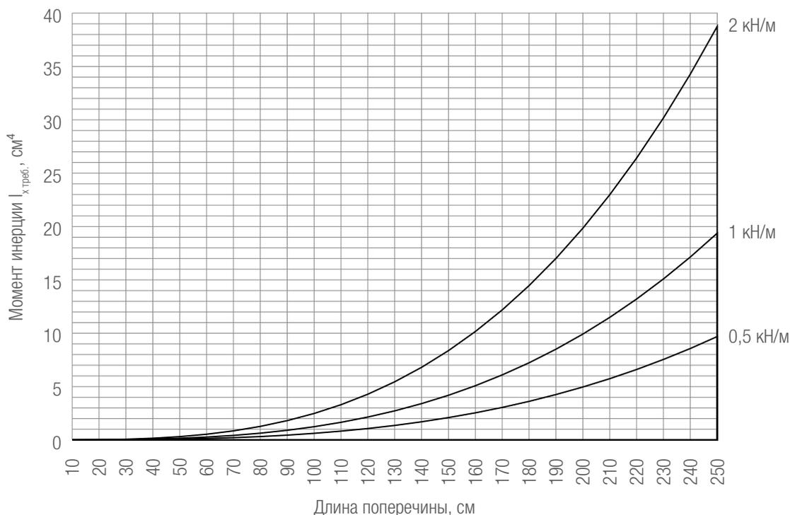
Рисунок 8: Расчётная диаграмма для определения требуемого момента инерции поперечины в зависимости от значения действующей эксплуатационной нагрузки ( $f = L/200$ ,  $E = 210000 \text{ Н/мм}^2$ )
