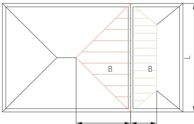
Рисунок 4: разбиение площади оконной конструкции на „грузовые поля“
