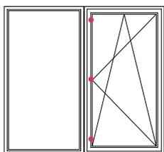
Соединение элементов с глухим остеклением и створкой, со стыком створки по всей длине соединения:
