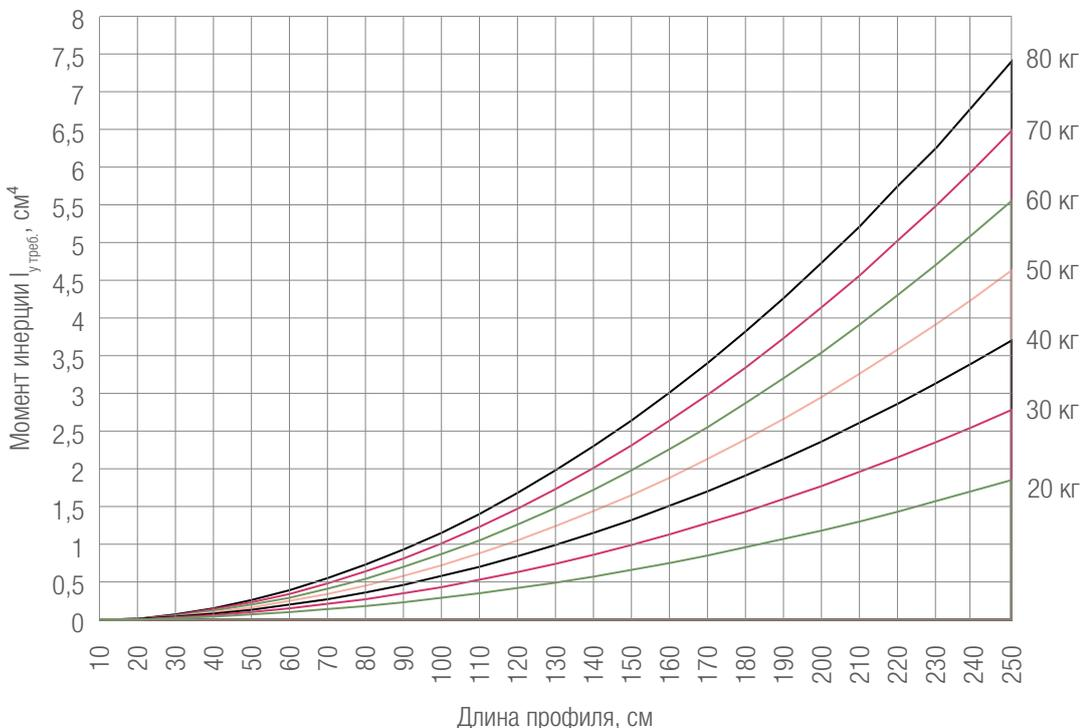
Рисунок 10: расчётная диаграмма для определения требуемого момента инерции поперечины в зависимости от величины нагрузки, создаваемой собственным весом заполнения ( $f = 0,3$  см,  $E = 210000$  Н/мм<sup>2</sup>,  $a = 15$  см)
