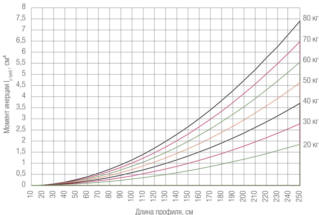
Рисунок 11: расчётная диаграмма для определения требуемого момента инерции створки в зависимости от величины нагрузки, создаваемой собственным весом заполнения (f = 0,3 см, E = 210000 Н/мм<sup>2</sup>, a = 15 см)
