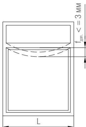
Рисунок 3: допустимые прогибы под действием собственного веса заполнения
